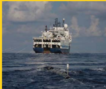
Seismik-Spezialschiff CGG Viking zur Erdölsuche mit 10 Sensorketten a 9 km Länge.
