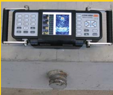
Multistatisches Ultraschallgerät für Beton (MIRA, www.acsys.ru)
