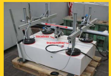
Ultraschall- Echo- Experiment an Polyamid zum Test verschiedener geophysikalischer Verfahren
