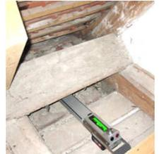
Bohrwiderstandsmessung IML Resi B300
