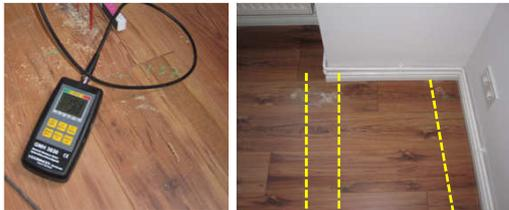
Holzfeuchtemessung; bei geringer Feuchte keine Fäulnisgefahr; rechts: Bestimmte Lage der Balken
